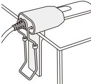
②使用する水槽サイズに合わせてステーの幅を調節してください。ステーに付属しているゴム状の部品(がたつき防止ストッパー)を本体にがたつきが出来ない場所にあわせて調節してください。さらにがたつきができる場合は付属の白いスポンジを水槽内面のガラスに挟んで固定してください。
